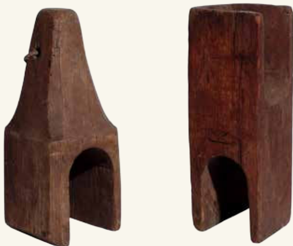
Fogmódlák, a nagykerék fogainak végéhez szolgáltak mintaként
