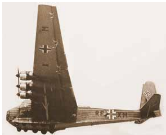
Messerschmitt Me 323-1 típusú Gigant hatmotoros szállítógép
